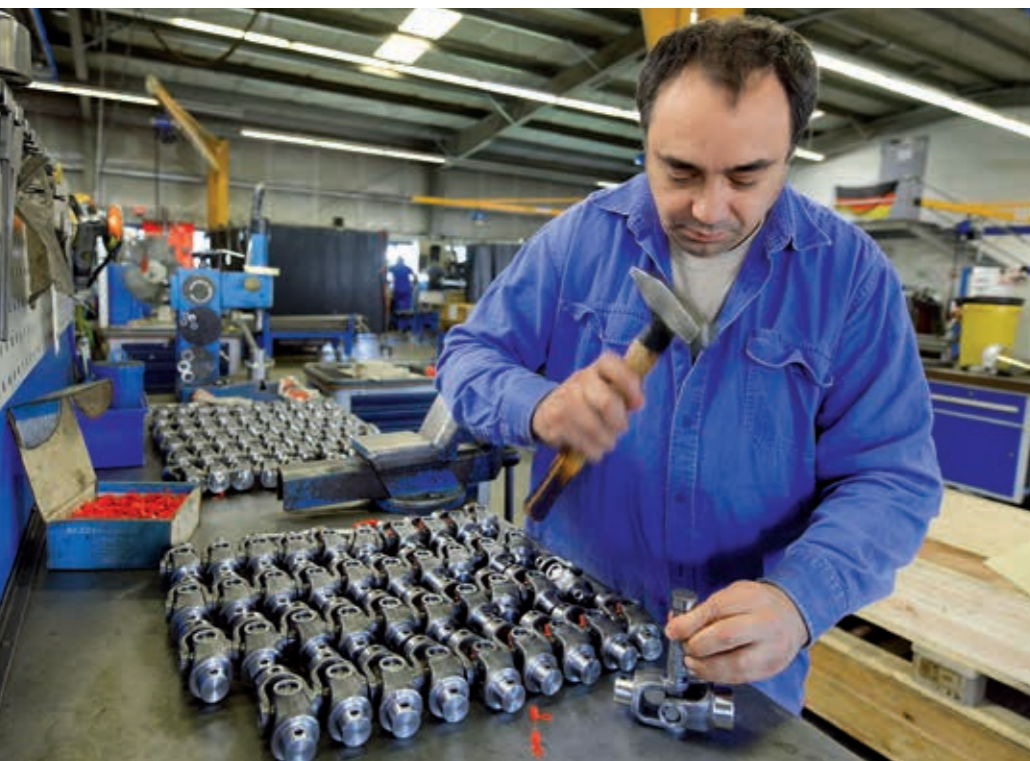
Handarbeit: Wladimir Mayer montiert Gelenkköpfe, die später an einer Welle fixiert werden.
